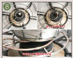
コンロの五徳が大きい場合は写真のようなサーポートリングを使用してください。 うちのは真ん中に安全装置がついているため サポートリングで押さえつけて使用しています。
